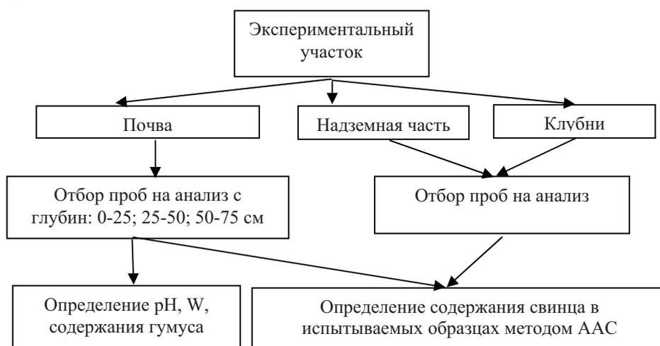
Рисунок 1 – Схема отбора и анализа проб
