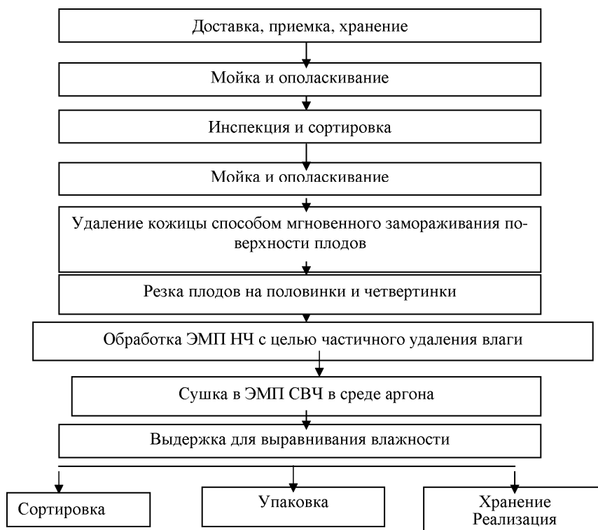
Рисунок 1 – Структурная схема производства сушёных томатов
