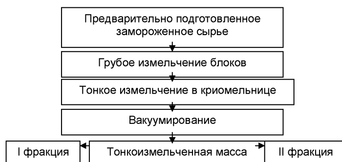
Рисунок 1 – Принципиальная схема разделения сырья на фракции
