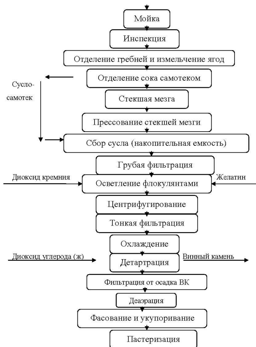
Рисунок 1 – Технологическая схема производства стабилизированного от кристаллических помутнений виноградного сока
