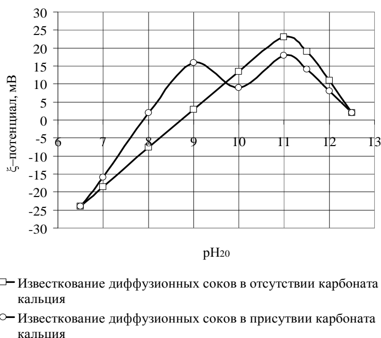
Рисунок 1 – Динамика изменения заряда частиц дисперсной фазы диффузионного сока при обработке известковым молоком
