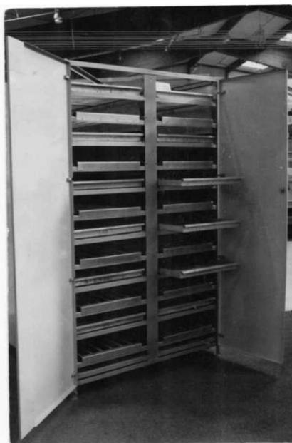
**Рисунок 1 – Опытно-промышленная инфракрасная установка**
