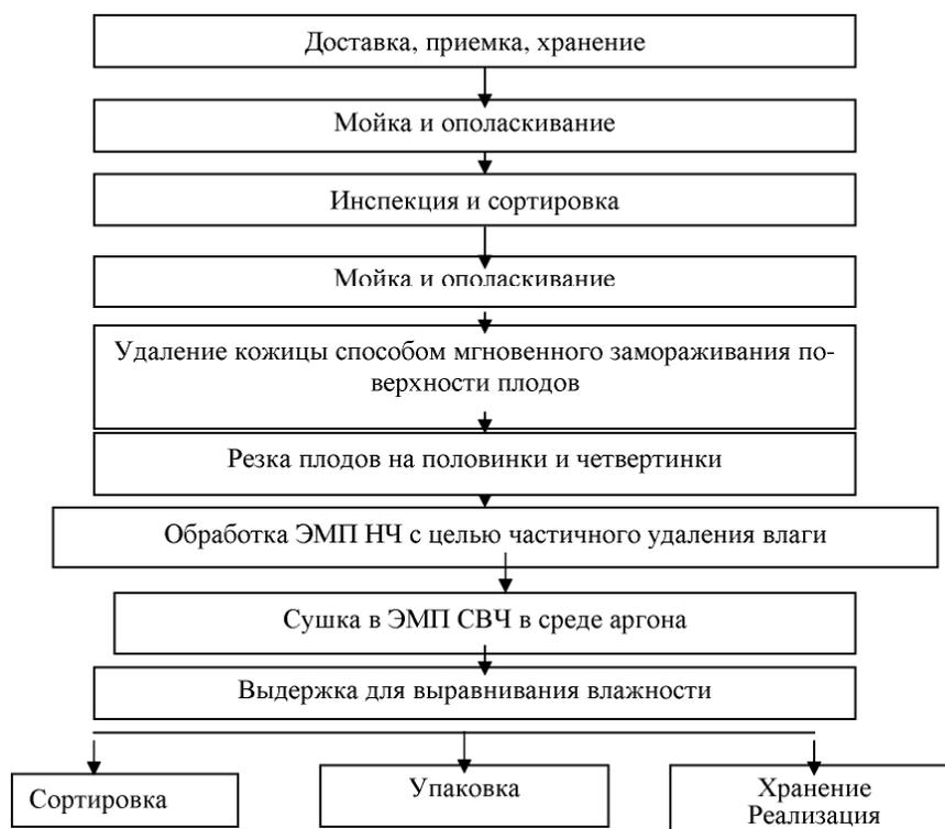
**Рисунок 1 – Структурная схема производства сушёных томатов**
