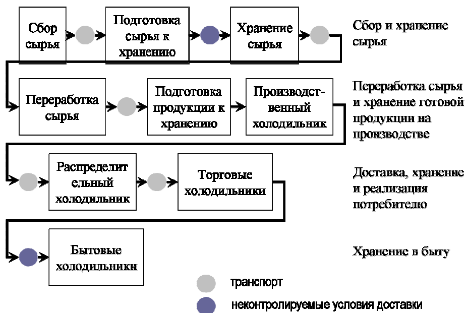
Рисунок 2 – Принципиальная схема холодильной цепи
