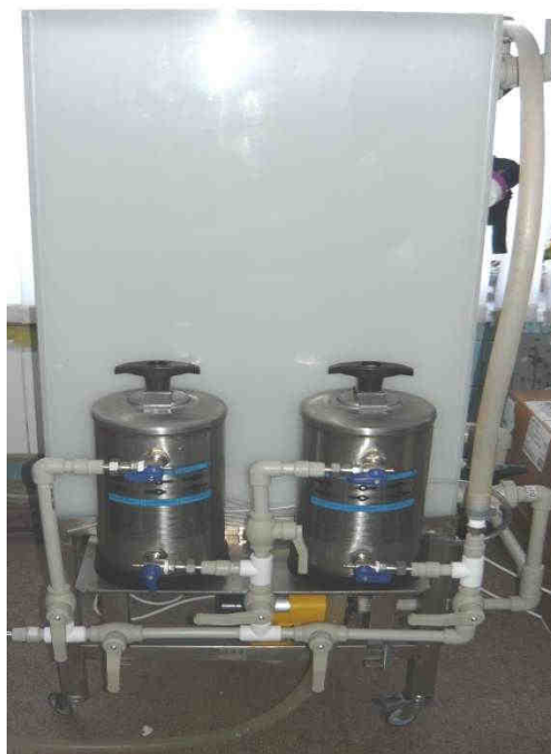
Рисунок 1 – Установка ионного обмена
