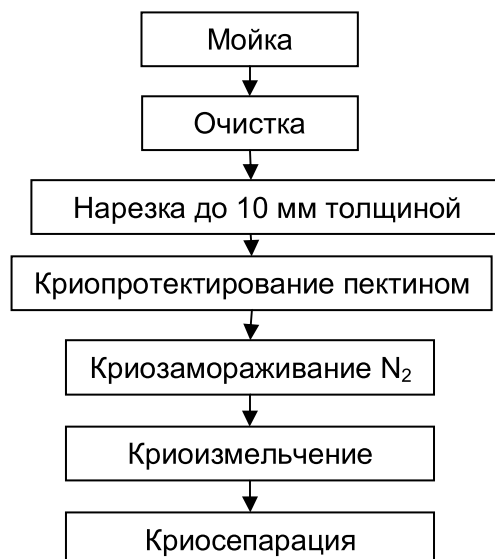
Рисунок 1 – Схема получения опытного криогидратного порошка из субтропического пищевого сырья
