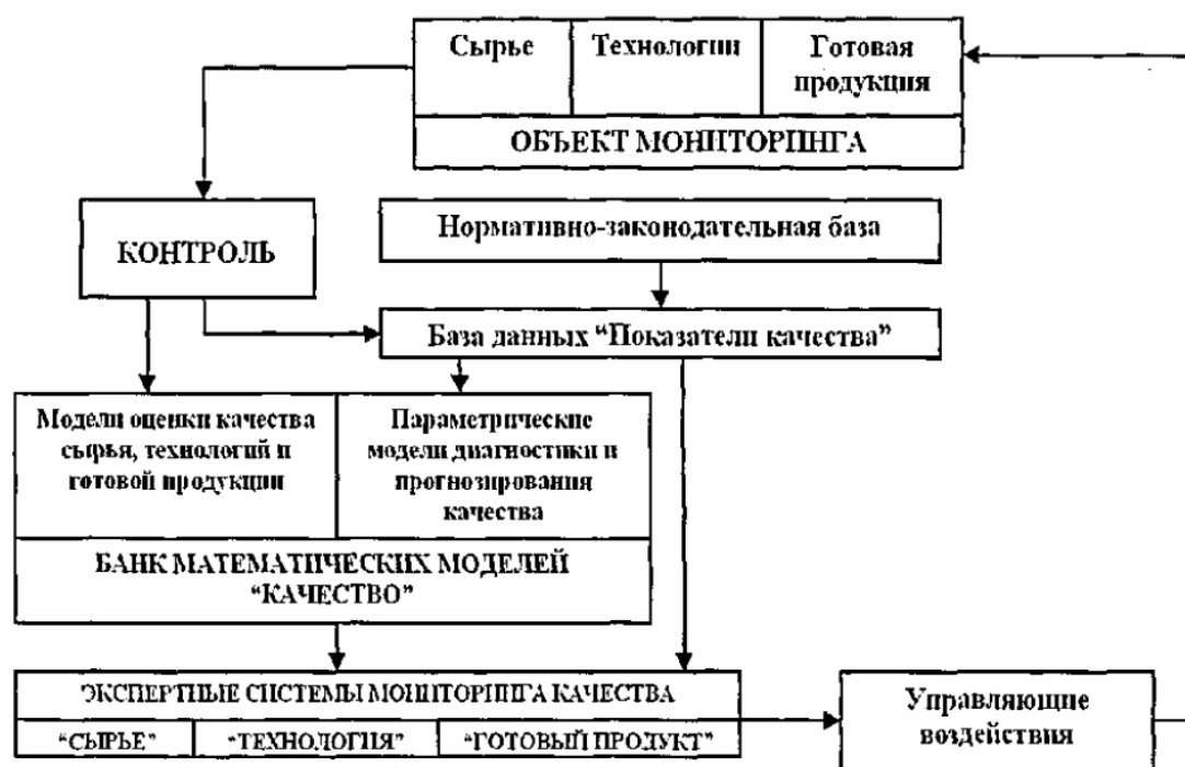
Рисунок 1 – Структура системы мониторинга качества продукции при производстве плодоовощных консервов
