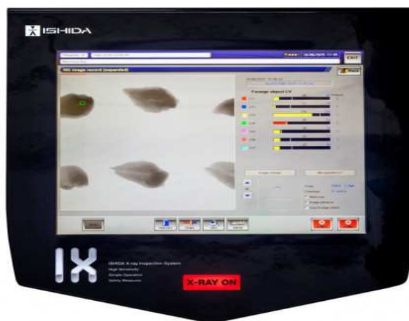
Рис. 2. Скриншот программы рентгеновской установки Ishida IX-G2
