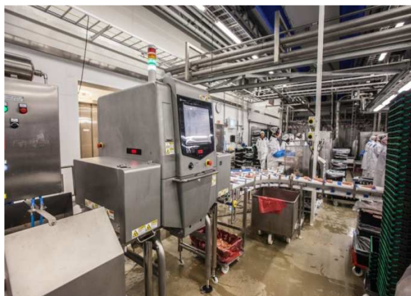
Рис. 1. Установка Ishida IX-G2 на линии производства компании Nortura
