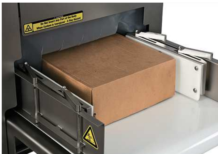
Рис. 5. Мясо, упакованное в картонную коробку, на конвейере анализатора Meat Master II
